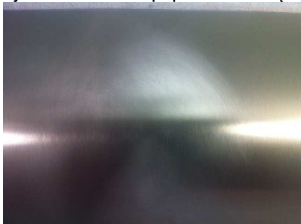
Rysunek 1. Blacha KO po polerce włókniną ścierną
